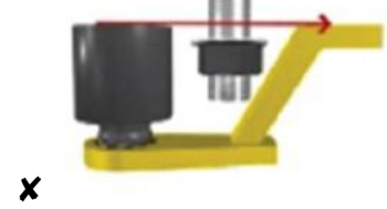
图6.7（错误的反力臂长度）
