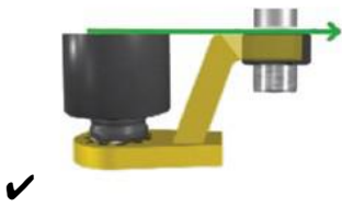
图6.5（正确的反力臂长度）
