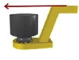
图6.4（错误的反力臂高度）
