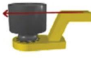
图6.3（错误的反力臂高度）
